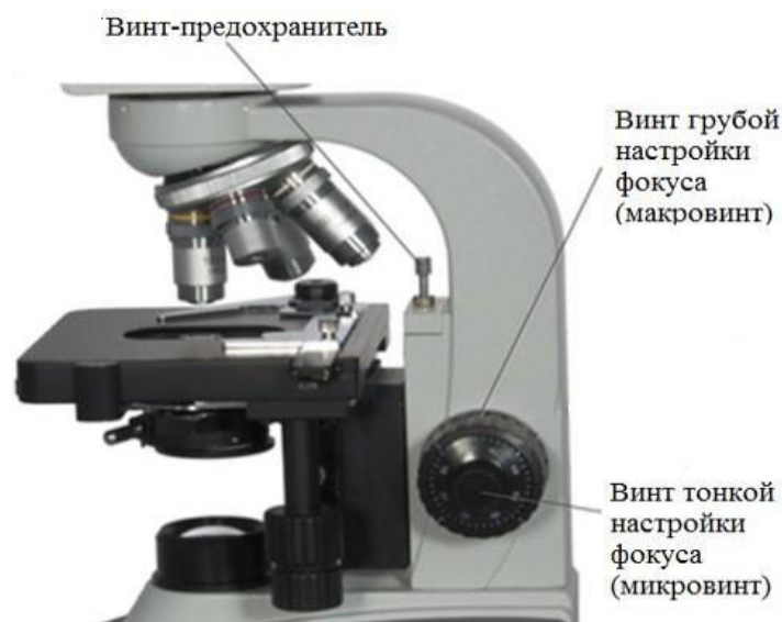
Рисунок 2 – Фокусирующий механизм микроскопа Биомед-5
